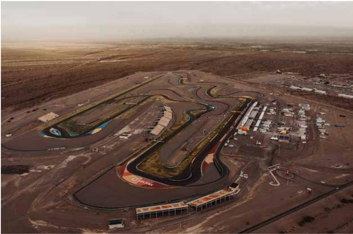
Ubicado en el departamento Albardón, el trazado tiene 4.254 metros, presenta constantes subidas y bajadas a lo largo del trazado, generadas artificialmente con un movimiento de suelo superior a los 700.000 m<sup>3</sup>. Cuenta además con dos circuitos alternativos de 3500 y 2500 metros de extensión.
